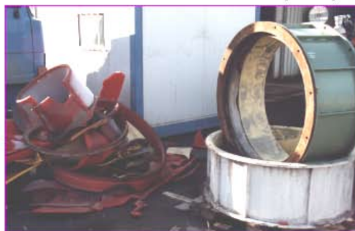
Vibroburatto con rivestimento asportato a pezzi
