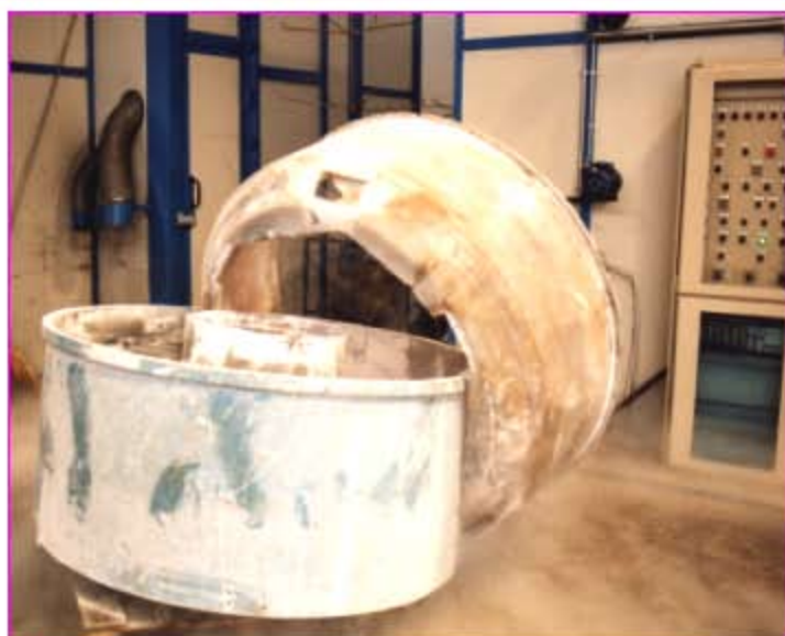
Vibroburatto con rivestimento asportato intero
