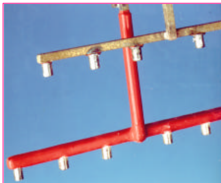
Attrezzi di galvanica prima e dopo la sviplatura
