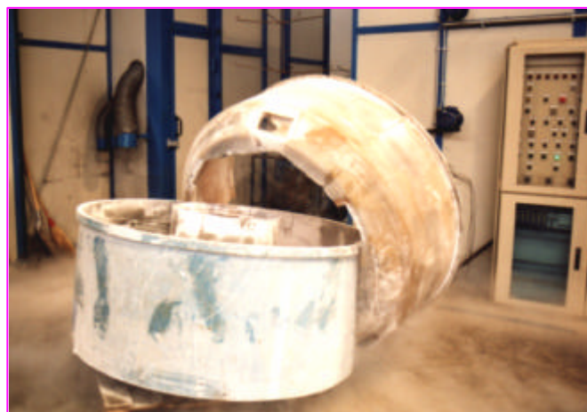
Vibroburatto con rivestimento asportato intero
